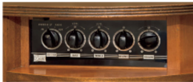
アンプのコントロールパネル。パワーアンプはEL34を2本使った15W クラス2台、パワーサプライ1台がバックスペースに搭載されている
