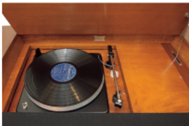
ターンテーブル部。エアサスペンションの上蓋を開けるとコラール社製ターンテーブル、その横にDECCA純正アームが装備されている
