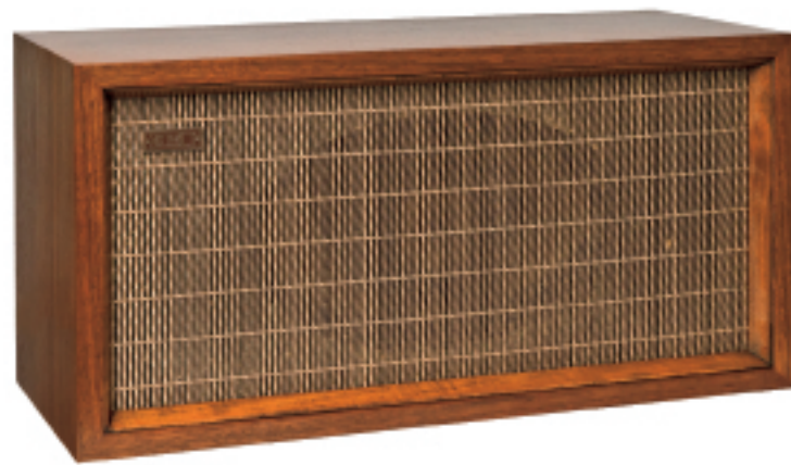
Model-319、Model-DSL 529 のフロントグリル。どちらのモデルも細い金属製のプレートを組み込んだ特注のグリルが採用されており、前面を殆ど金属に覆われていて透過率は40%もないように見えるが、これはユニットの前面に負荷が掛かるアコースティックレンズの役目の機能を果たした構造になっている
