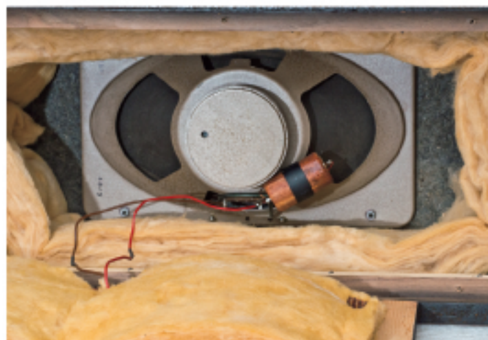
Model-319 内部の写真。同軸タイプのユニット92390-CLのフレームに L / C 型ネットワークが装着されている
