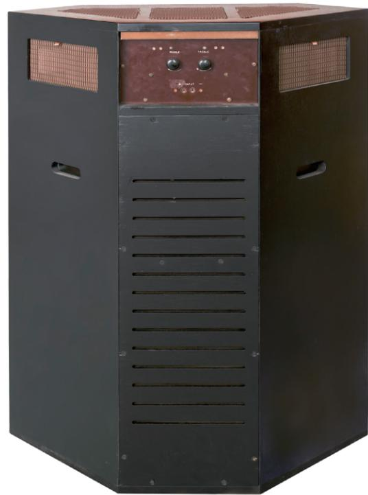
キャビネット後側の上部にトウイーターとミッドレンジ用のアティネーターのツマミが搭載されており、その両サイドにも四角いポートが開けられている。スリットタイプのバスレフポートは、コーナーにセットすると壁と本体の隙間から壁を反射して低音が部屋に放出される仕組み
