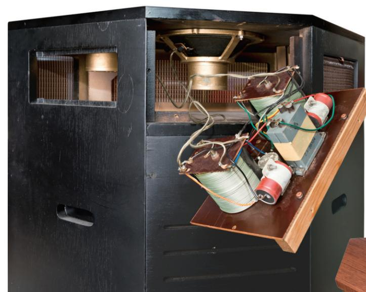
アッテネーターの板を外すと強力なマグネットを持つトウイーター、ミッドレンジユニット、大型のコイルとオイルコンデンサーで構成されたネットワークが確認できる
