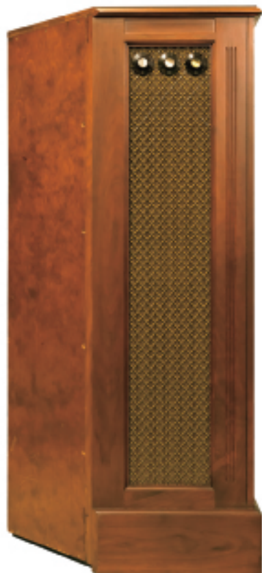
46cmウーファーを搭載したバックロードホーンで増幅された低音は両サイドの縦のスリットから斜め前方に放出される。左側のスリット上部にはアッテネーターが3個取り付けられている。
