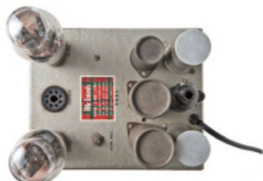
50W-2のパワー部。電源部の整流回路には5U4Gを2本搭載。特許を持つパイファイバー巻トランスとユニティカップドサーキット回路により、歪み率0.5%以下を実現
