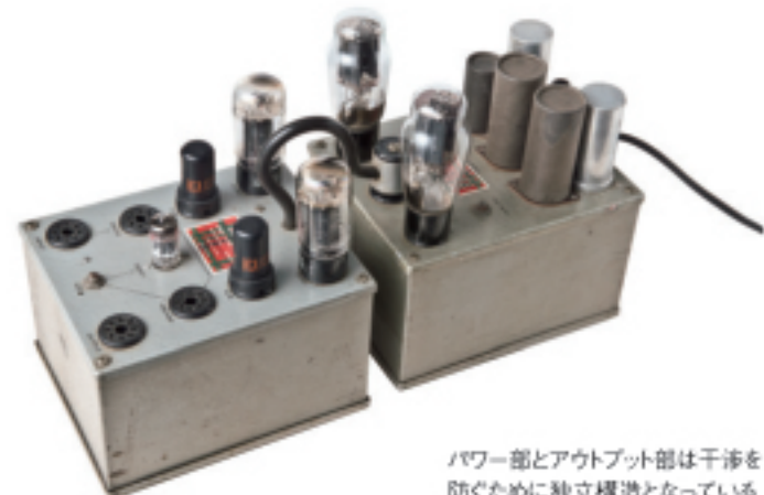
50W-2のパワー部。電源部の整流回路には5U4Gを2本搭載。特許を持つパイファイバー巻トランスとユニティカップドサーキット回路により、歪み率0.5%以下を実現
