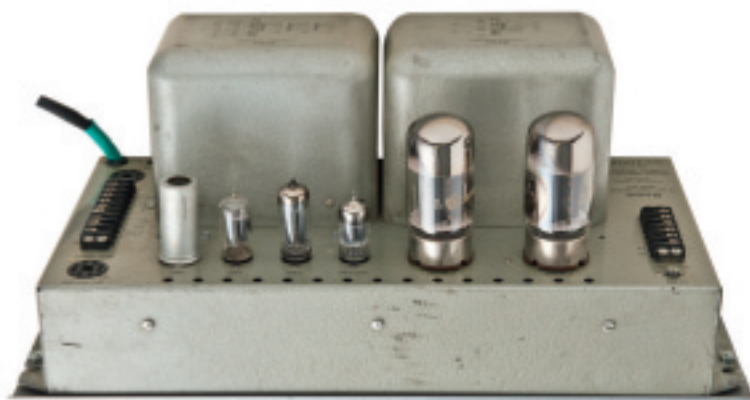
真空管側の写真。トランスのカー形状と真空管レイアウトはMC-75タイプと同じ、スピーカー端子、入力用端子もこちら側にレイアウトされている
