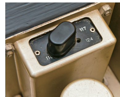
電源トランスの対応電圧切り替えプラグ
