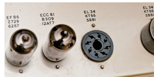
対応真空管の表示。このアンプはシャーシの真空管の表示の部分にKT-66、5881、EL-34とあり、同じ真空管がペアチューブならそのまま入れ替えることが可能で、それぞれ違った音色が楽しめる
