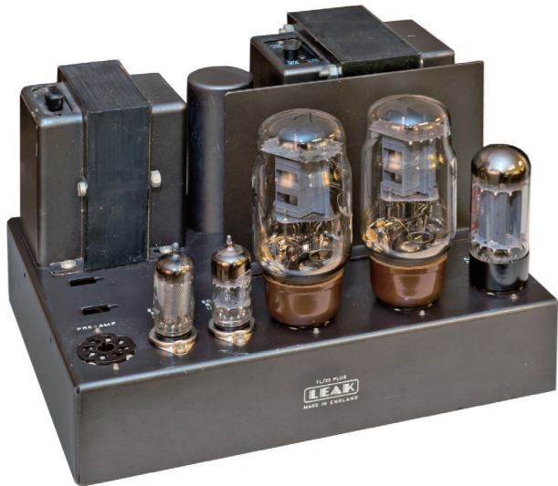
コンパクトなモノラルパワーアンプ「TL-25 Plus」。1951年に開発されたプロ用パワーアンプ TL-25-Aの改良型で、コンシューマー用途をメインとして開発されたと思われる。トランスは英国で有名な Partridge 製。出力管はKT-66が2本で、整流管はGZ-34が1本。増幅段にはEF-86が1本と、ECC-81が1本搭載されている
