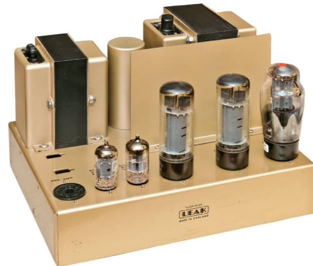
コンパクトなモノラルパワーアンプ「TL-25 Plus」。1951年に開発されたプロ用パワーアンプ TL-25-Aの改良型で、コンシューマー用途をメインとして開発されたと思われる。トランスは英国で有名な Partridge 製。出力管はKT-66が2本で、整流管はGZ-34が1本。増幅段にはEF-86が1本と、ECC-81が1本搭載されている
