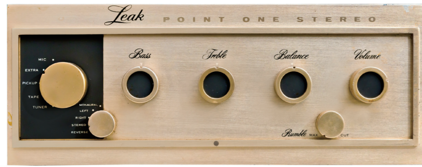
「Leak Point One Stereo」の正面パネル。左から大きなツマミが入力セレクター、Bass、Treble、Balance、Volumeの順。下の小さなツマミに関しては、左側がMood (mono/Stereo)セレクター、右側はRumble filter
