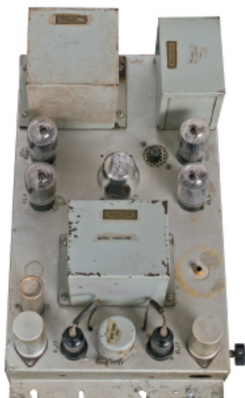
搭載トランス。角型のトランスカバーで内部にビッチで振動止めされたパーマロイコアのトランスが搭載されている。手前中央がアウトプットトランス、右奥がチョークトランス、左奥が電源トランスである
