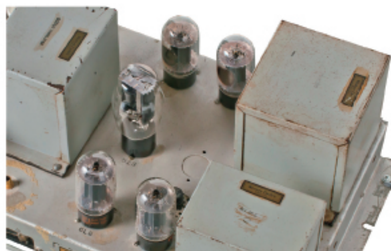
電源部/出力部。電源用の整流管は5Z3が1本、出力管には6L6(今回の個体は6L6GB)が4本搭載
