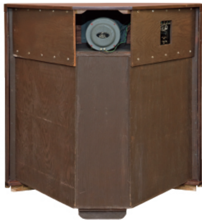
背面側。天板は背面上部分のネジを外すと上に外れる構造になっていて、さらにホン/ドライバーを外すとウーファーボックスのフタがあり、それを開けると150-4Cウーファーが斜めに装着されている
