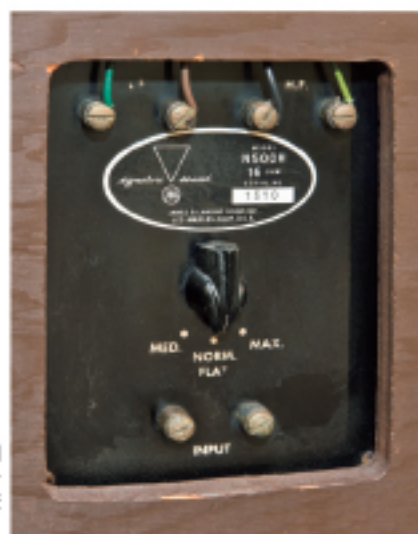
N500ネットワーク。シアター用に開発されていたものをコンパクトなケースに収納して3ステップの音量調整が採用されている
