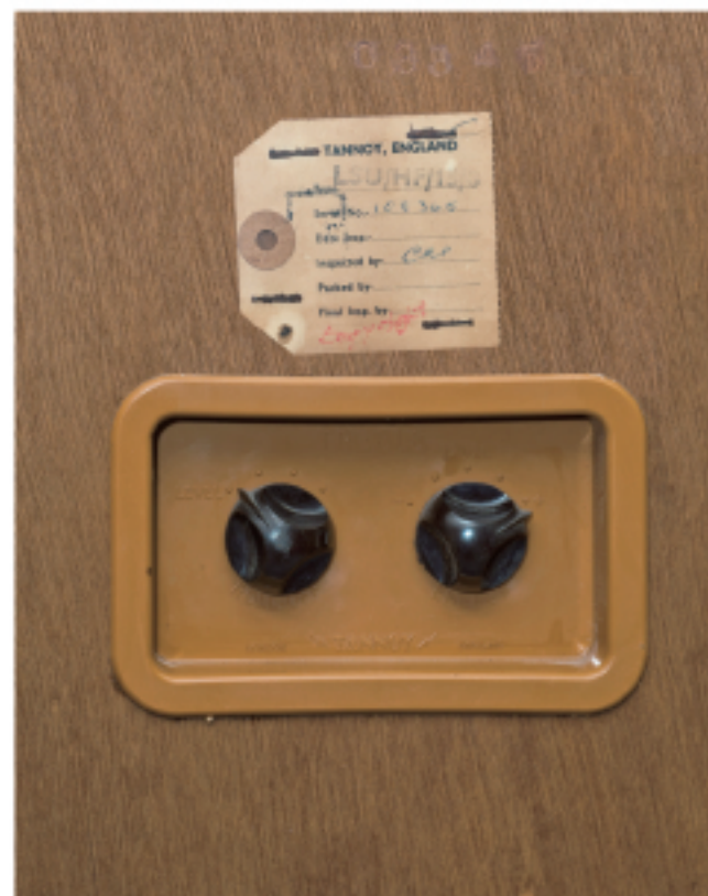
アッテネータと当時の製品タグ。ゴールドタイプは5ROLL-OFFとENERGY の2個の高域アッテネータが付く。紙製のタグには Autograph と表記されており、ユニットの番号も記載されている
