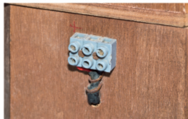
スピーカーターミナル。ケーブルをプラスチックの上にある四角い穴に差し込み正面の丸い穴からマイナスドライバーで締めて固定する仕組み
