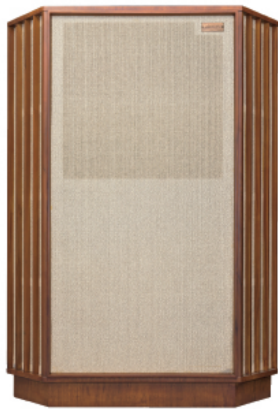
キャビネットの正面。本体は全て12mm厚のベニア材で構成されており、見た目の大きさとは違いあまり重量がない。特に英国オリジナル Autograph は良く低音が出て響きが良いのが評判だが、この軽く良く共鳴するキャビネットがその秘密となっている
