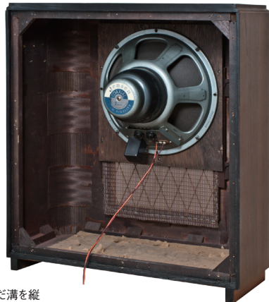
C-151 cabinet 内部の写真
