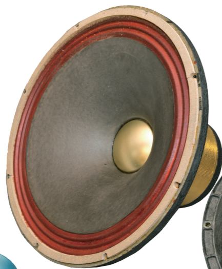
150-FR. アルミのセンターキャップに赤く塗られた布製のハードエッジタイプで、JBLのD-130と150-4Cを合体させたような特性のユニットである。コーン紙も薄く張りがあるため、ハイスピードで抜けの良い音になっている。またエッジを布製のハードエッジにしたことで、耐久性も上がり、今に至っても劣化が少なくオリジナルの音質特性を保っている個体が多い。
