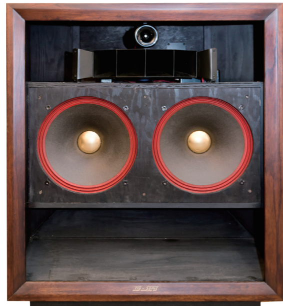
Model-629にサラネットを外して正面からみたところ。キャビネットは全て米松材で構成され、フロントのサラネットは、キャビネットの下の方向に引き出す構造になっている。ウーファーユニットは同じタイプが2機搭載されており、構造は縦に返し型のバックロードホーンタイプとなっている。初期型は2ウェイ・システムでP-52LX / 38cm ユニットと、8セルのホーンH-824に、P-15ドライバーが搭載されていた。後にユニットが103-LXとP-208 ホーンドライバーに変更され、最終型は38cm 150-FRユニット、4セルホーンH-814にP-216ドライバー、さらにT-212トウイターが搭載された3ウェイ・システムとなる。サイズ 113H×91W×46Dcm。
