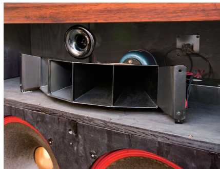
H-814/P-216 ホーンドライバー、T-212トウイター、P-216用のX-800ネットワーク。H-814 ホーンはアルミの板を折り曲げて作られており、ホーン内部には鳴き止め用のピッチが充填されている。
