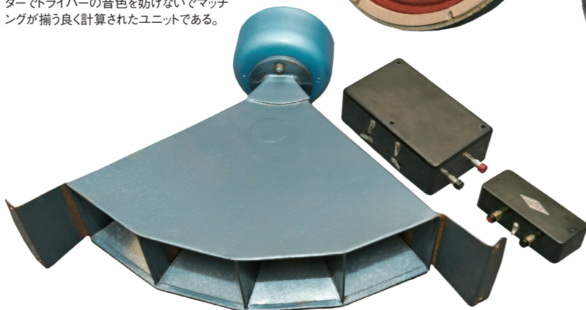
P-216. 814ホーン、800 Hz / 5000 Hz ネットワーク。1インチ程度のアルミ製ダイアフラムを搭載していて、当時のドライバーとしては珍しい小さな丸い穴が複数空いているマルチスロータイプを採用。これはこの当時に世界的にもTru-sonicが最初で、その後Tannoyのドライバーユニットにも採用されている。
