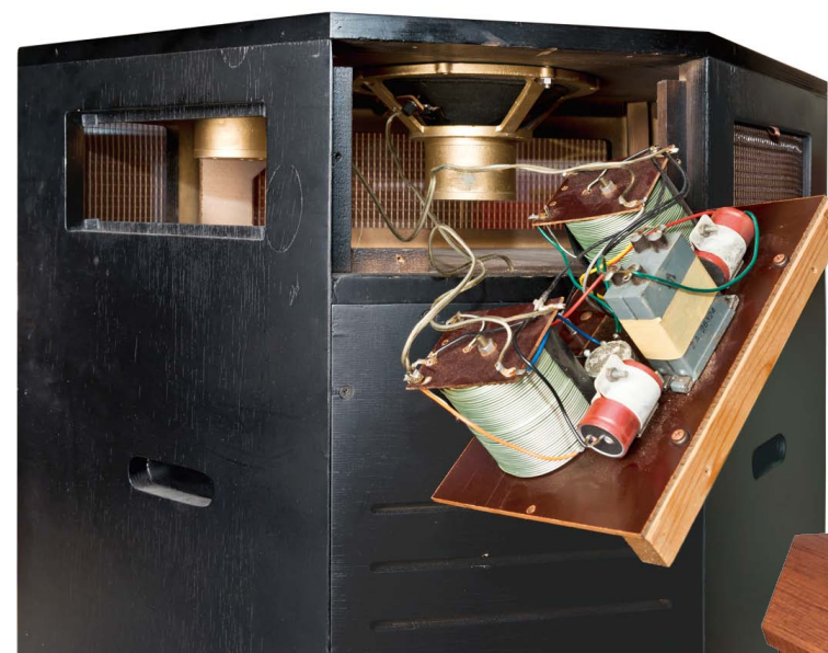
アッティネーターの板を外すと強力なマグネットを持つトゥイーター、ミッドレンジユニット、大型のコイルとオイルコンデンサーで構成されたネットワークが確認できる
