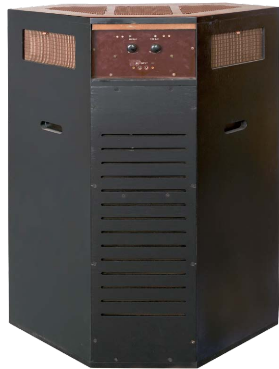
キャビネット後側の上部にトゥイーターとミッドレンジ用のアッティネーターのツマミが搭載されており、その両サイドにも四角いポートが開けられている。スリットタイプのバスレフポートはコーナーにセットすると壁と本体の隙間から壁を反射して低音が部屋に放出される仕組み
