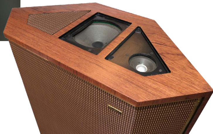
上から見ると六角形になっていてユニットの正面が確認できる。トゥイーター、ミッドレンジはどちらも紙製の振動板である。また、この後期型はトゥイーターのセンターキャップがアルミに変更されており、より高域の繊細な表現が可能になっている
