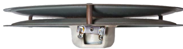
「Omni Directional tweeter」。湾曲した2枚の金属製の円盤がイコライザーとして採用されている。中心部分にトウィーターユニットが上向きに装着。このダイアフラムはフェノリック製樹脂で形成されており、耳障りのやわらかい滑らかな音質を生み出している
