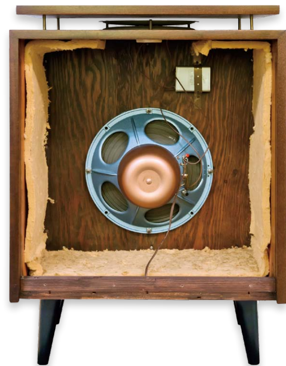
Kingdom後面の内部。キャビネットのほぼ中央に30cmユニットが搭載されており、トウィーターはイコライザーユニットの中心部分に上向きに装着されている
