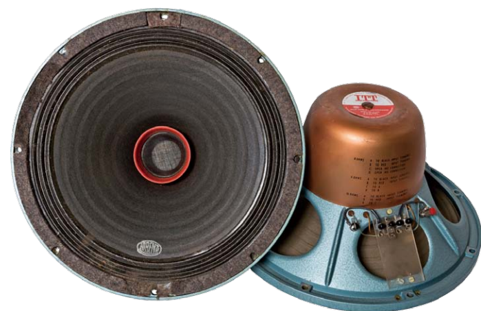
「LP-312 woofer」。フルレンジに近い30cm口径の同社の主力ユニットで、LPH-65トウィーターを搭載した同軸型ユニットにも同じタイプが採用されている。紙のシングルコーンでエッジ部分のサスペンションが3段になっていて、豊かな低音再生を可能にしている。初期型と後期型があり、このシステムにはセンターにサブコーンを搭載した後期タイプが採用されている
