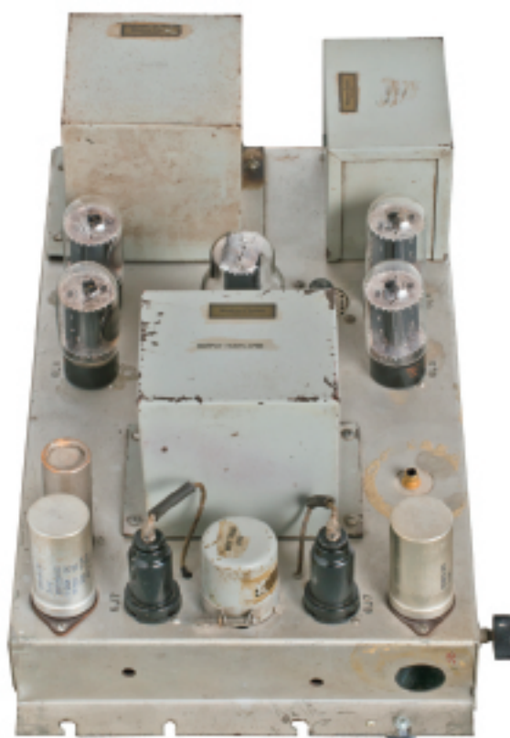
入力部。インプットトランスには618-Cが搭載され、6J7 2本で増幅される
