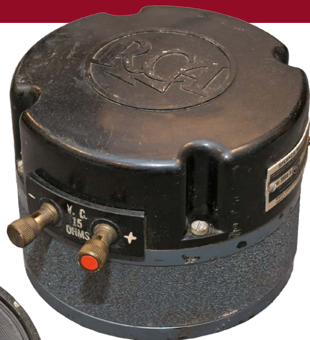
「MI-9548」のドライバー。フェニリック樹脂製の1.8インチ振動板を持つRCAの大型ドライバーで Western Electric 社の594ドライバーに対抗して開発されたフィールドタイプ。RCA MI-1443ドライバーのアルニコタイプとして数多くの当社のシステムに装着されている
