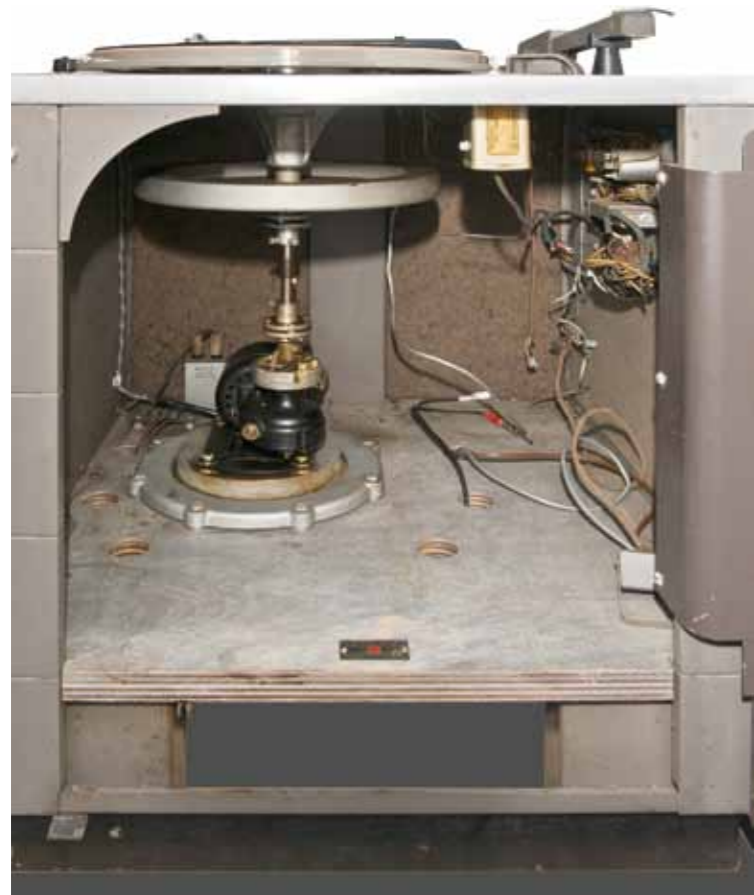
RCA 70-D 内部。ギアドライブ用のRCA製モーターと重量級のフライホイール、キャビネットの内側には吸音用と思われる厚みのあるフェルト材が張られている
