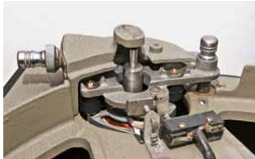
本体上部はアルミの一体成形でできている、中央のプーリーを画面左側のレバーをプラッターに押し当てて固定する機構になっている
