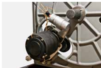
モーター部分は振動吸収のあるゴムが本体との間に挟まれている
