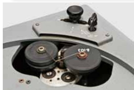
2個のゴム製のアイドラーがそれぞれ33、45、78回転をコントロールする
