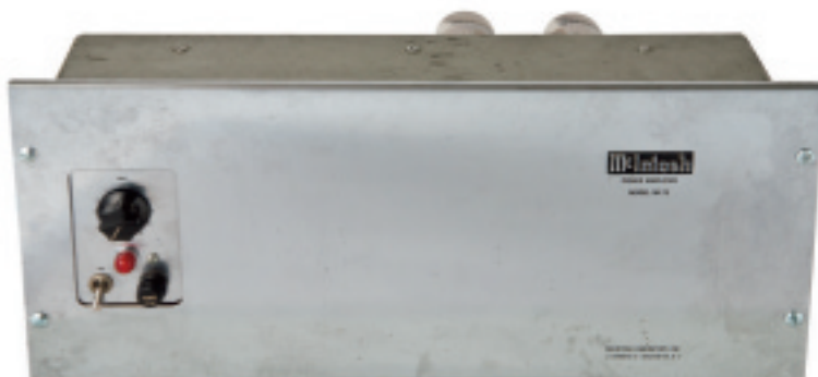
MI-75のフロントパネル。左側に電源スイッチと出力ボリューム、ヒューズホルダーがマウントされている
