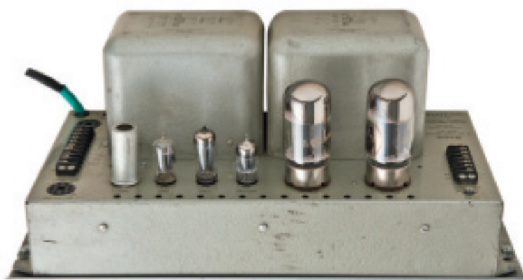
真空管側の写真。トランスのカー形状と真空管レイアウトはMC-75タイプと同じ、スピーカー端子、入力用端子もこちら側にレイアウトされている
