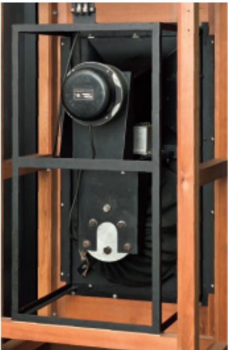
オイロダイイン「KI.L439」のリア部。ホーンドライバーと38cmウーファーが頑強な鉄製アングルの枠に取り付けられている。
