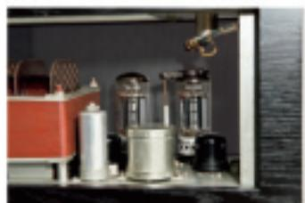
右手前の黒い管が低い真空管が増幅段のEF-12で、奥の大きい真空管が高出力管のF2a11である。
