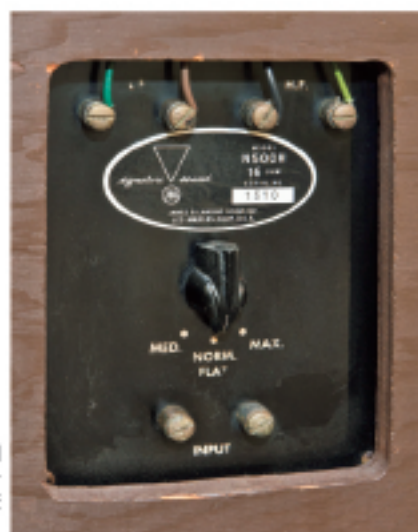
N500ネットワーク。シアター用に開発されていたものをコンパクトなケースに収納して3ステップの高域調整が採用されている
