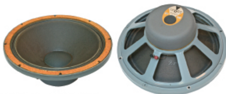
150-4C ウーファー。1953年にウエストレックスのシステム用に開発されたT-510Aが原型。JBLの130シリーズのフレームとマグネットは同種だが、サブリングが装着され、外注と思われる真鍮製の深いウーファーコーンが採用されている。このウーファーコーンのタイプは当時の Triu-Sonic や JENSEN の大型スピーカーに採用されたウーファーによく見られる
