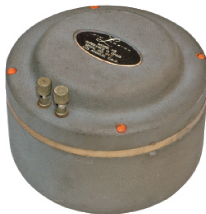
375 ドライバー。1953年にウエスタン4インチのダイアフラムを持つ594Aフィールドコイルタイプ。これをパーマネントマグネットタイプとして開発したT-530Aがその原型となる。初期型の375はグレー塗装のバックカバーが少し盛り上がったタイプで、JBLのシステムで最初に搭載されたのはハーツフィールドである。このドライバーはJBLの主力のユニットで数種類あり、1980年代頃までの大型のシステムに搭載されていた
