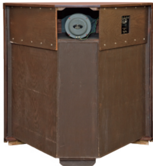
背面側。天板は背面上部分のネジを外すと上に外れる構造になっていて、さらにホーン/ドライバーを外すとウーファーボックスのフタがあり、それを開けると150-4Cウーファーが斜めに装着されている
